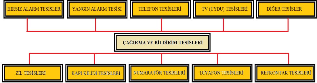
Şekil 1.1: çağırma ve bildirim tesisleri dalları
